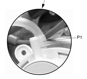
"Р1"- указывает на место присоединения силиконового шланга для измерения давления воздуха!
